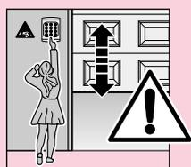
Festinstallierte Steuerungsgeräte (wie Taster etc.), sind in der Sichtweite des Tores zu montieren, aber entfernt von sich bewegenden Teilen und in einer Höhe von mindestens 1,5 m. Sie sind unbedingt außer Reichweite von Kindern anzubringen!
