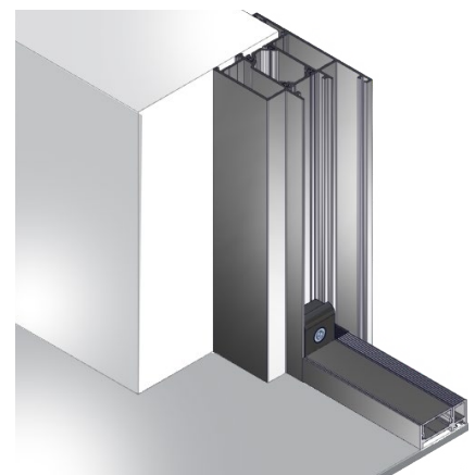
F: Montage im lichten Maß mit Abdeckleiste außen
