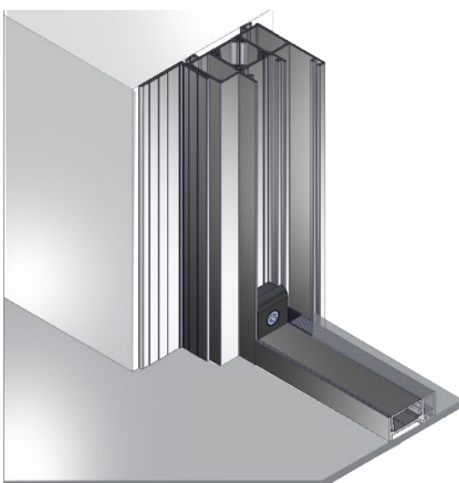
D: Montage im lichten Maß mit Montageprofil schmal
